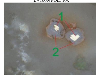
Рис 4. 1-пирит, 2-гидроксид железа. Nikon ECLIPSE LV100N POL. 10x
